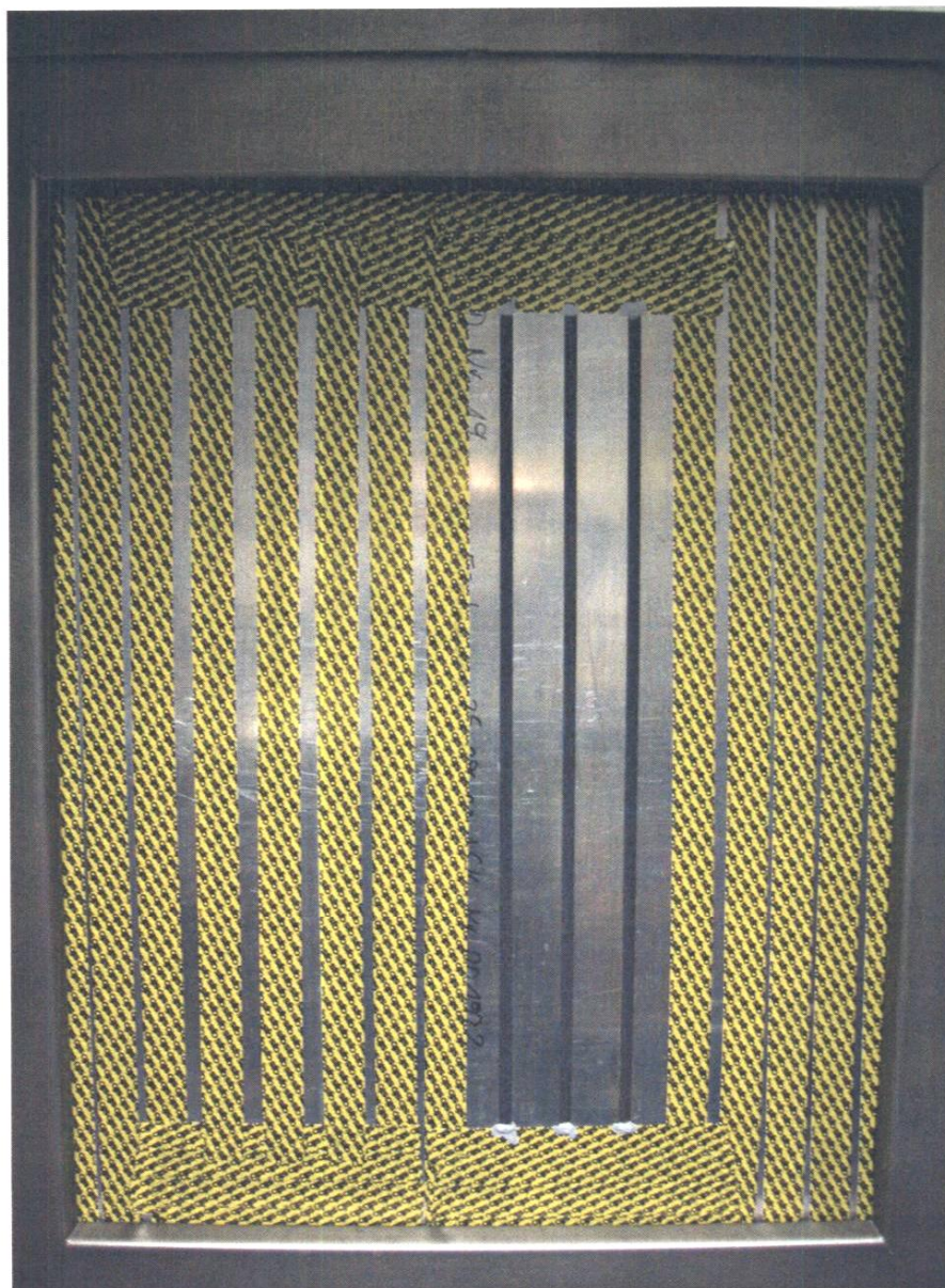
Bild 6: Versuchskörper für Längsfugen im Beregnungsstand
