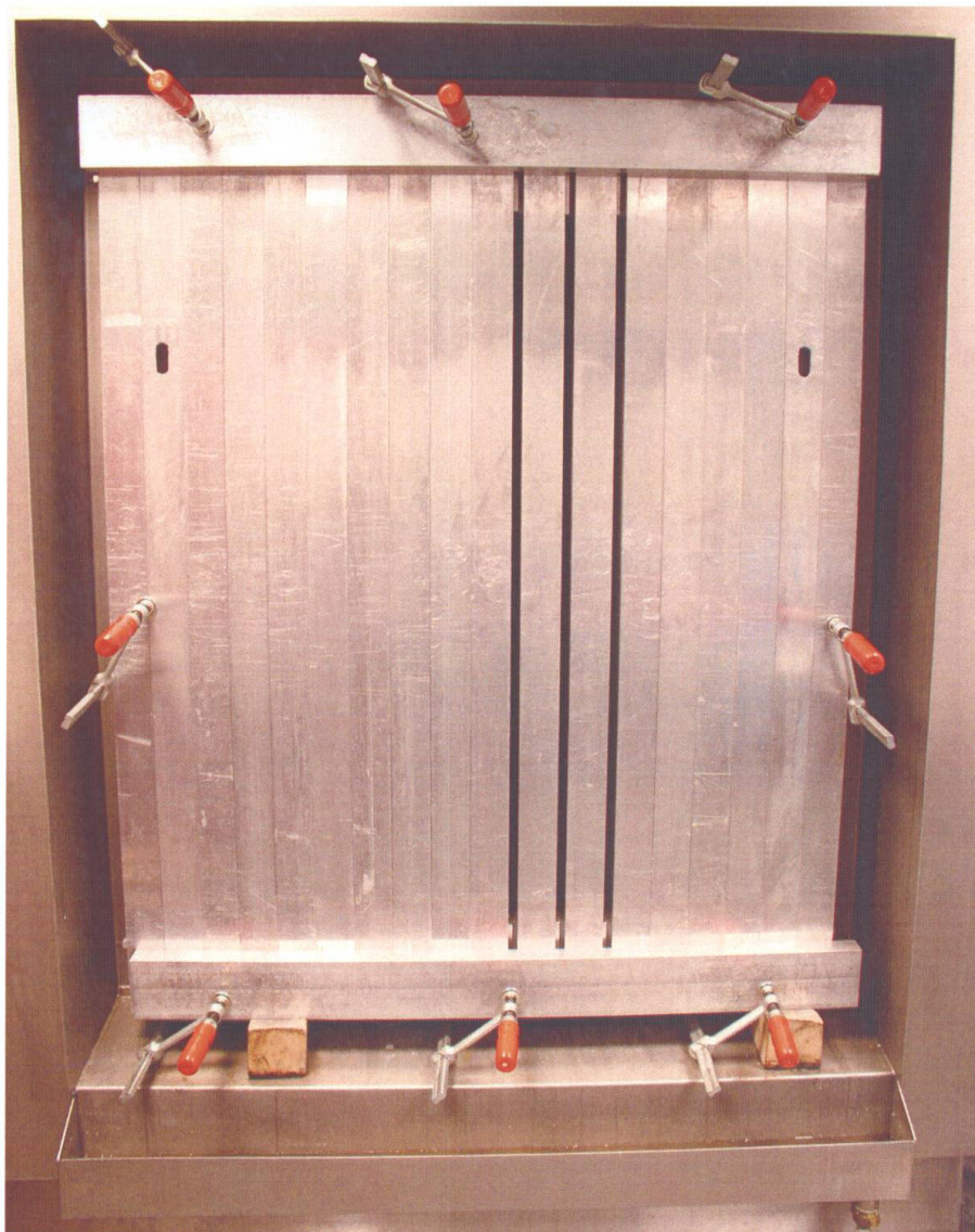
Bild 5: In den Versuchsstand eingebauter Prüfkörper (Längsfugen)
