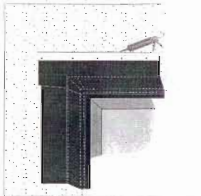
Obr. 4: Konečná fáze - dotěsnění pojistnou lištou tmelem Festix OT 11
