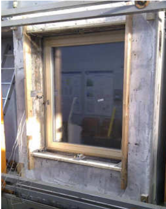
Bild 1 Probekörperansicht von der Raumseite mit angebrachten Verformungsaufnehmern
